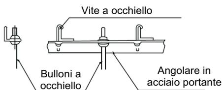
2. Installare e montare i tubi e i cavi dopo aver terminato l'installazione del corpo principale. Al momento di scegliere dove iniziare, determinare la direzione dei tubi da estrarre. Soprattutto se la si deve installare a soffitto, allineare i tubi del refrigerante, i tubi di scarico e le linee interne ed esterne con i rispettivi punti di collegamento prima di montare l'unità.
