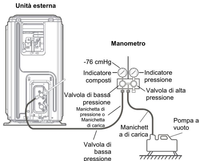
6. Chiudere il lato di bassa pressione del manometro del collettore e spegnere la pompa a vuoto.
