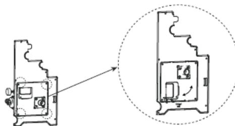
4. Installare le parti della pompa sulla macchina e collegare il set di cablaggio.
