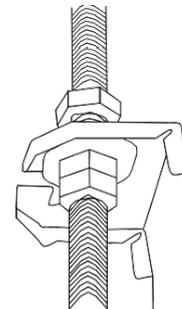
9. Posizionare l'unità interna in piano utilizzando un livello per evitare perdite.
