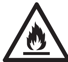
Attention : Risque d'incendie
